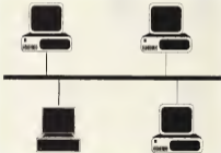
Figura 1 - Topologia di rete a bus. Tutte le stazioni sono collegate ad un unico mezzo di trasmissione unico.
